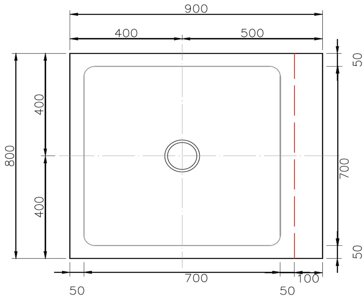
PREINSTALLAZIONE SCARICO ONDA
